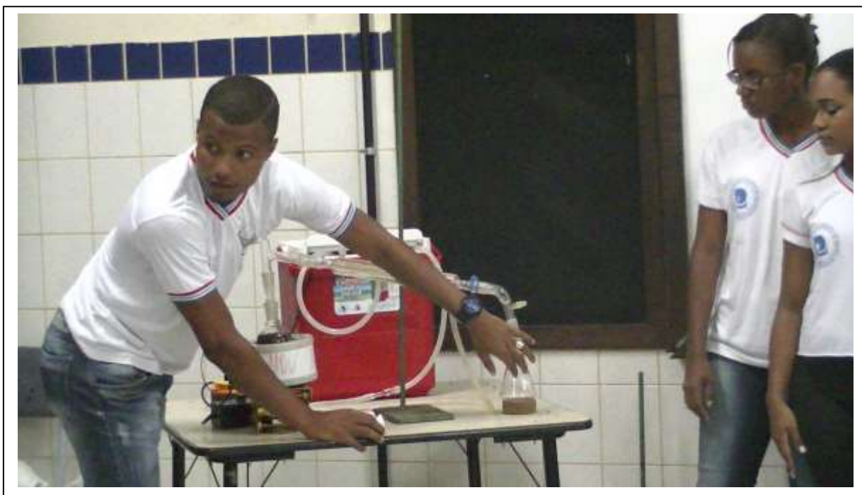
Imagem 3: Detalhe da apresentação do experimento sobre Extração do Óleo do Cravo-da-Índia por Arraste a Vapor.
